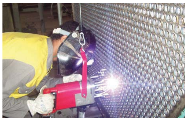
Exemple d'application avec tubes affleurants et tête TS 2000
