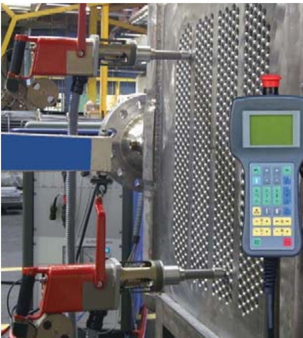
Exemple d'application de soudage de tubes en retrait
