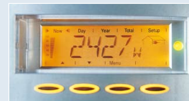
Displej Fronius Personal Display zobrazuje aktuální údaje až 15 střídačů.
