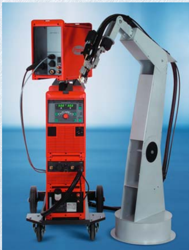
MagicWave 5000 и роботизированная сварочная горелка Robacta TTW 4500 с механизмом подачи электродной проволоки KD-Drive
