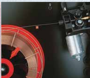
2-роликовый привод обеспечивает хорошую подачу проволоки
