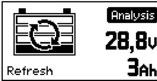
分析阶段期间，充电设备会监控蓄电池电压，该分析结果将用于后续充电过程。
