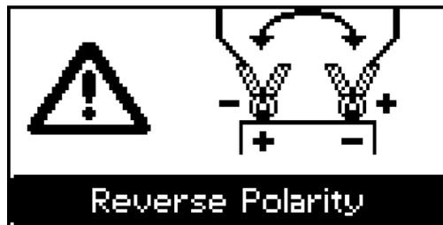
充电缆反极性，反极性保护装置触发
