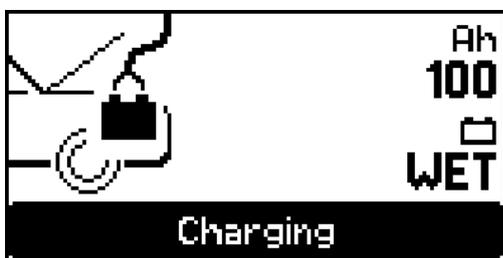
连接至电源后，充电设备会自动启动充电模式。
