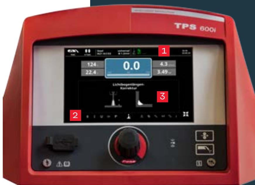
Grafische Anleitungen und dynamische Visualisierungen bei Parameteränderungen unterstützen den Anwender direkt. Die Bedienung erfolgt mittels zentralem Dreh-Drückknopf oder über den Touchscreen. Die Schweißfachkraft kann sich somit voll und ganz auf die Aufgaben konzentrieren.
