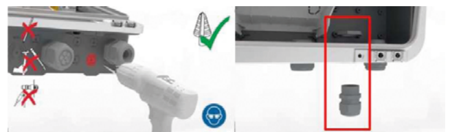
Rysunek 3: Nawiercenie falownika i umieszczenie dławika przewodowego PG w modyfikowanym obszarze.
