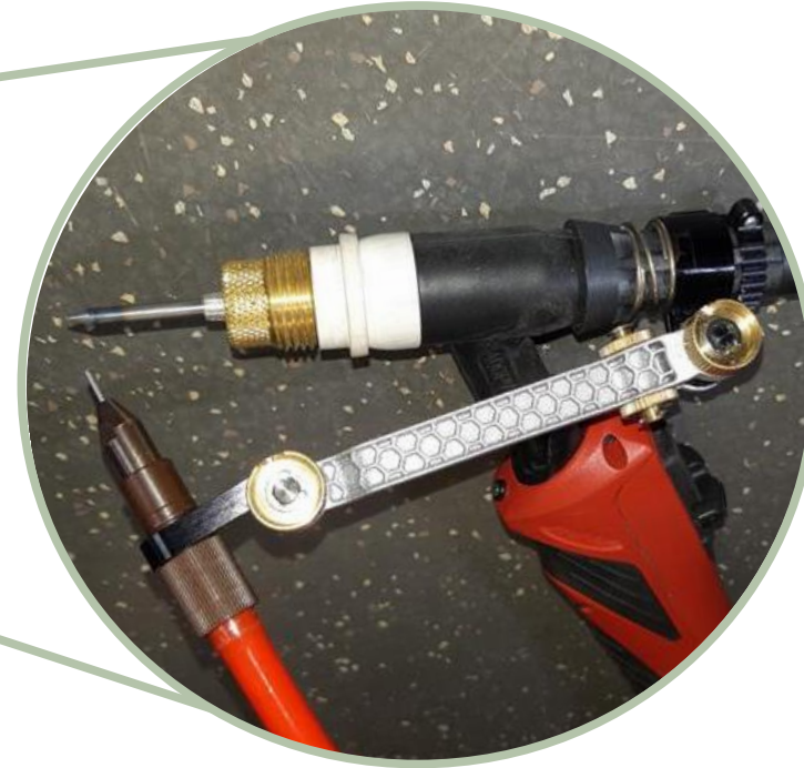
Elektrodenwechsel mittels TFC System
