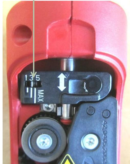
Empfohlener Anpressdruck ist am Deckel angegeben
