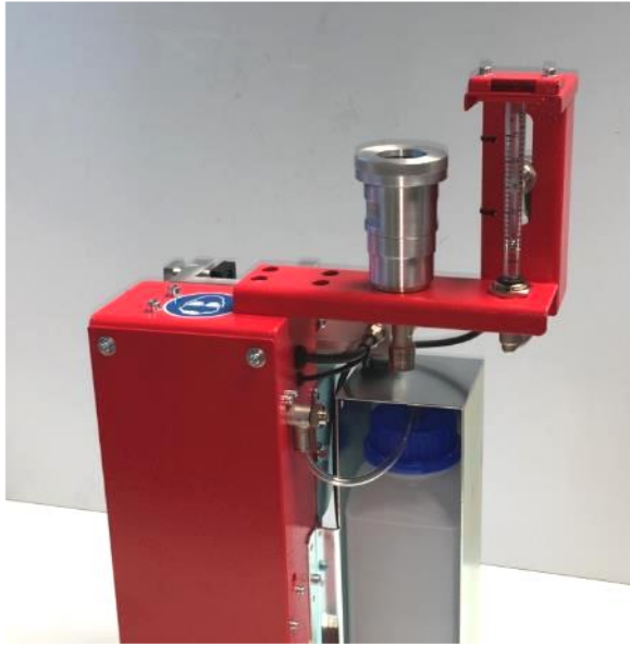
Gasmengenkontrolle Basic montiert auf Robacta Reamer
