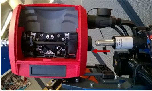
**Step 1:** Schlauchpaket ohne Spannippel an der Splitbox anschließen
