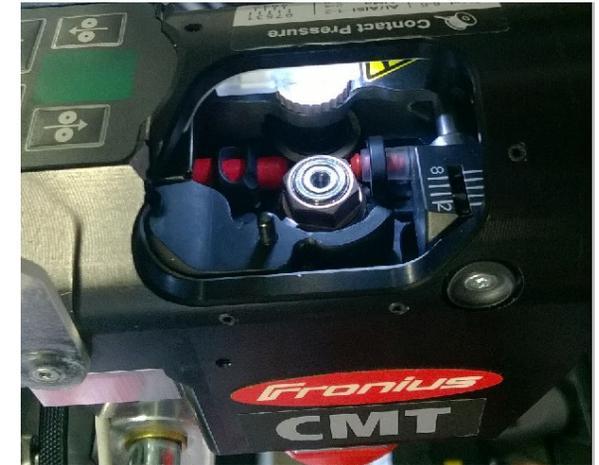
LED zum Ausleuchten der Verschleißteile
