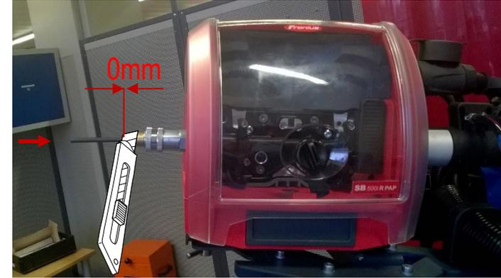
**Step 3:** Seele von hinten durch die Splitbox bis zum Anschlag in der Antriebseinheit montieren
