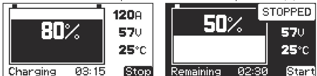
L'icona della batteria serve per indicare lo stato di carica attuale. Lo stato di carica della batteria viene indicato in percentuale.
