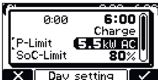
Limitazione della potenza ("AC power limit") è modificabile in intervalli di 0,5 kW.
