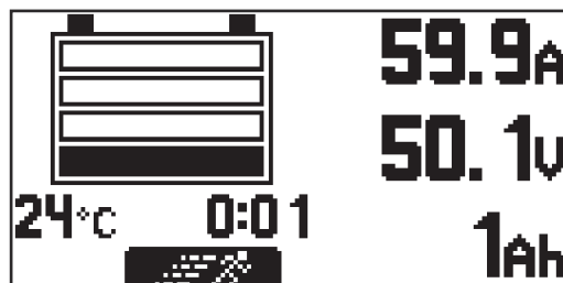
Displej při zvolené charakteristice (např. IUI)
