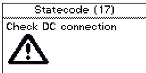
Если во время зарядки с подключением постоянного тока возникают проблемы, отображается сообщение о состоянии 17 (если активирован параметр проверки подключения постоянного тока). Если зарядные контакты изношены или загрязнены, может возникнуть проблема с подключением.
