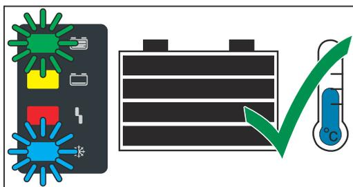
Чтобы обеспечить оптимальный срок службы аккумуляторной батареи, отсоединяйте ее от зарядного устройства, только когда светятся синий («Аккумуляторная батарея холодная») и зеленый индикаторы, как описано ниже. Если используется несколько зарядных устройств, сначала отсоединяйте аккумуляторную батарею, которая была полностью заряжена на протяжении более длительного периода времени (самую холодную).
