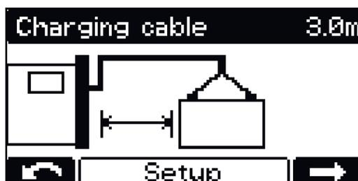
10 При помощи кнопок Up/Down (Вверх/вниз) задайте соответствующую длину зарядного кабеля (m / ft).
