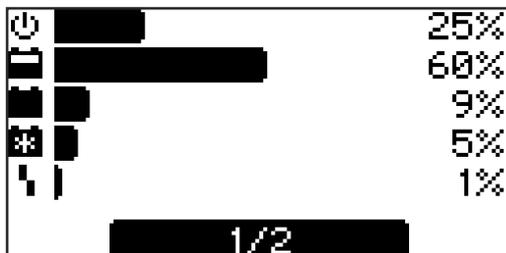
В режиме статистики горизонтальные полосы отображают частоту возникновения следующих рабочих состояний устройства:
