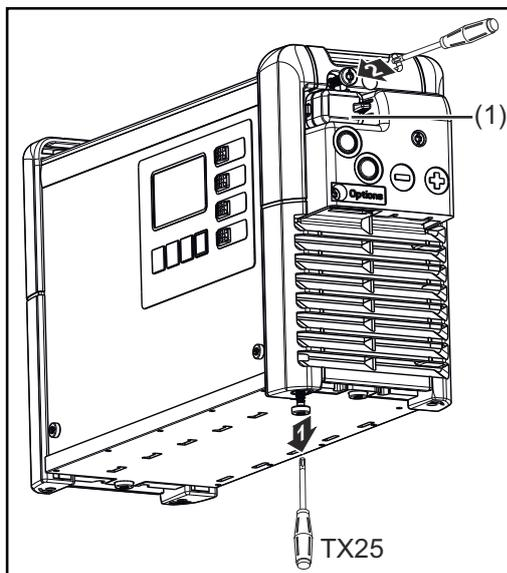
Крышку (1) разъема USB можно зафиксировать с помощью винта.
