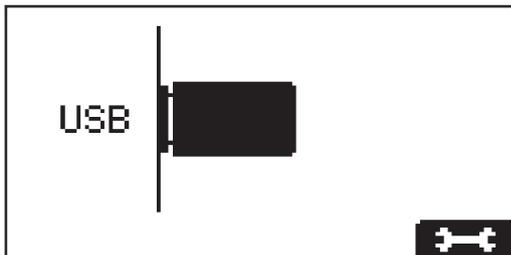
В режиме USB на дисплее отображается информация о том, подключен ли USB-накопитель.
