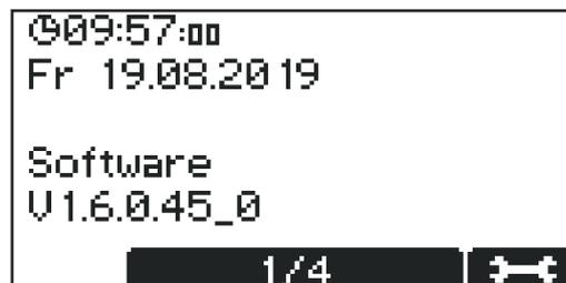
Сначала экран отображается в исходном формате с указанием даты, времени и версии программного обеспечения.
