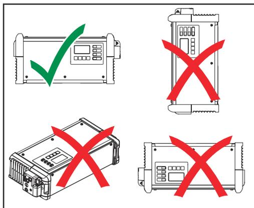
Допустимое рабочее положение устройства — горизонтальное.
