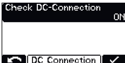
Настройка Check DC Connection (Проверка подключения постоянного тока) содержит параметры для проверки разъема переменного тока. Если проверка разъема переменного тока включена (ON («Вкл.»)), соединение между зарядным устройством и аккумуляторной батареей проверяется во время зарядки.
