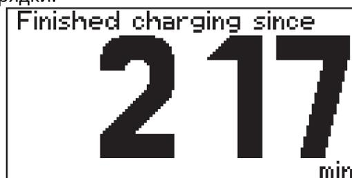
Символ аккумуляторной батареи указывает на текущее состояние зарядки. Количество отображаемых столбиков указывает на ход выполнения зарядки. Сразу после того, как аккумуляторная батарея будет полностью заряжена, отобразится счетчик минут (см. цифру справа). Он отсчитывает минуты с момента окончания зарядки и в условиях использования нескольких зарядных устройств позволяет определить ту аккумуляторную батарею, которая остыла сильнее всего.
