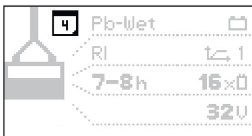
Если функция календаря активирована, на дисплее отображается соответствующий символ (обозначен здесь цифрой 4).
