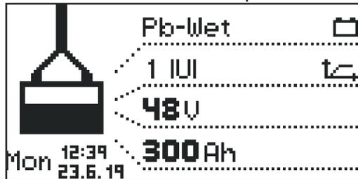
В стандартном режиме на дисплее отображаются следующие параметры зарядки:
