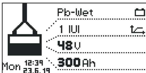
Индикация на дисплее отображается в стандартном режиме. На дисплее отображаются параметры зарядного устройства:
