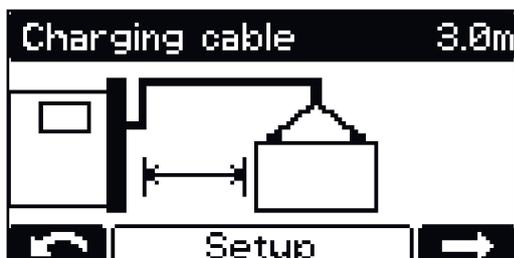
10 使用“上/下”按钮设置合适的充电电缆长度 (m / ft)。
