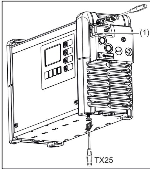
可通过螺钉紧固 USB 接口的防护盖 (1)。
