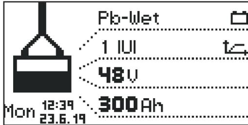
显示屏随后将以标准模式显示。显示屏会显示蓄电池充电器参数：
