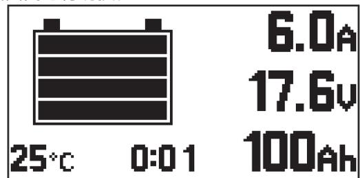
当蓄电池充满电后，蓄电池符号的所有 4 个电池条均显示为黑色。绿色指示灯将在蓄电池充满电后点亮。
