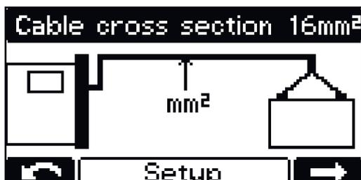
12 使用“上/下”按钮设置合适的充电电缆截面积 (mm<sup>2</sup> / AWG)。
