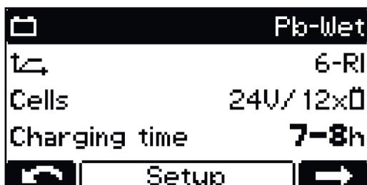
14 如果所显示的充电配置正确无误，请使用“暂停/启动”按钮确认充电配置。
