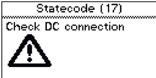
如果在充电过程中出现直流连接问题，则在进行直流连接检查时，会设置状态代码 17。如果充电触点磨损或脏污，则会出现连接问题。
