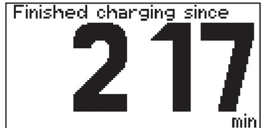
蓄电池符号表示当前的充电状态。显示的格数越多，说明充电时间越久。蓄电池一充满电，就会出现一个分钟计时器（请参见右图）。该计时器会计算多长时间前充电结束（以分钟为单位），在使用多个蓄电池充电器时，更容易判断哪个蓄电池的温度最低。
