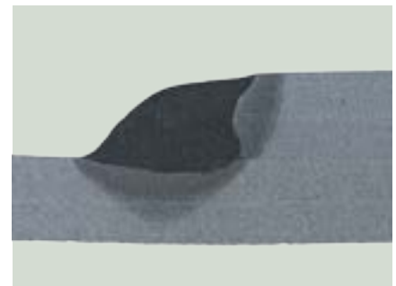
Lead: Strom [A]: 440, Spannung [V]: 34,8, vs [cm/min]: 330 Trail: Strom [A]: 340, Spannung [V]: 27,2, vs [cm/min]: -
