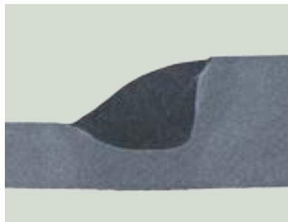
Strom [A]: 406, Spannung [V]: 33,1, vs [cm/min]: 140
