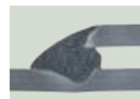
Lead: Strom [A]: 280, Spannung [V]: 28,0, vs [cm/min]: 110 Trail: Strom [A]: 125, Spannung [V]: 17,0, vs [cm/min]: -
