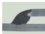
Courant [A] : 155 ; tension [V] : 12,3 ; vs [cm/min] : 30
