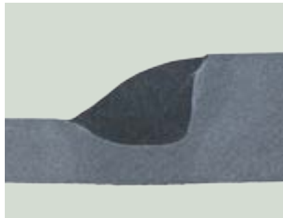
Courant [A] : 406 ; tension [V] : 33,1 ; vs [cm/min] : 140
