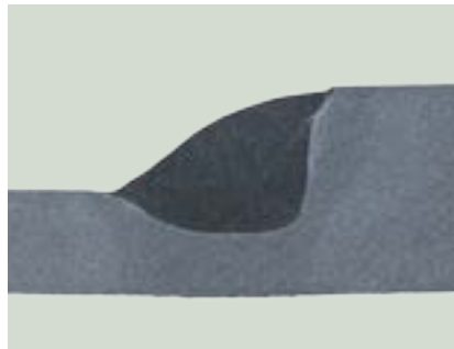
Áram [A]: 406, Feszültség [V]: 33,1, vs [cm/perc]: 140
