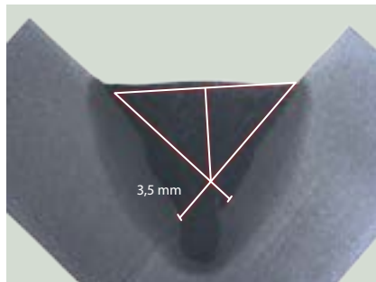
Áram [A]: 406, Feszültség [V]: 33,1, vs [cm/perc]: 40
