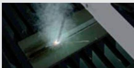
Secuencia de formación de soldadura manual por arco voltaico
