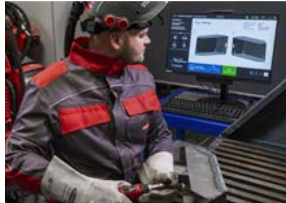
**2** Step by Step: Ein Display zeigt visuell die Arbeitsschritte in der definierten Reihenfolge und die entsprechenden Schweißparameter werden automatisch eingestellt.
