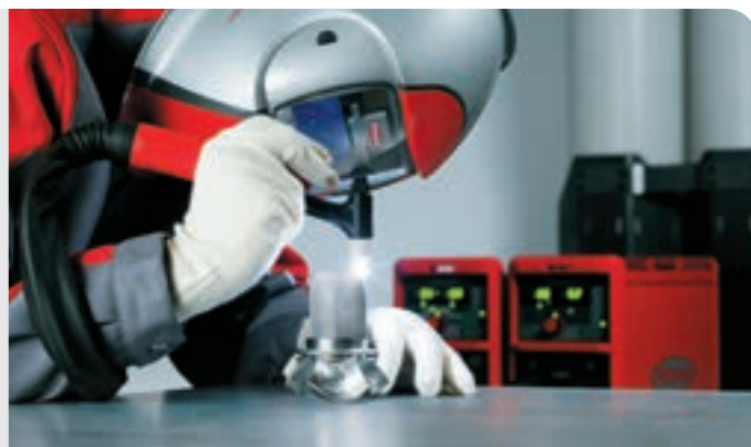
/ Manuelles Mikroplasma-Schweißen für Blechdicken ab 0,1 mm.
