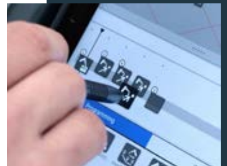
Programmerstellung per Drag & Drop
