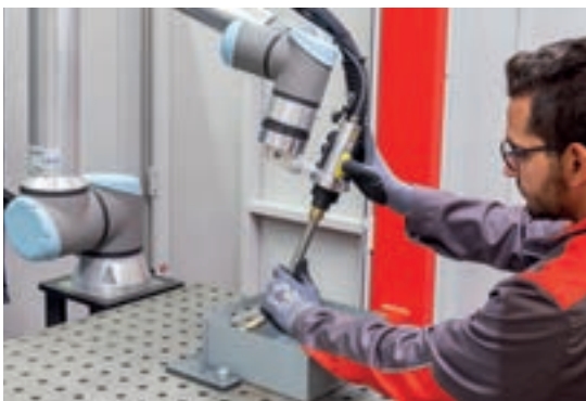
/ Einfache Programmierung durch direktes Führen des Brenners
