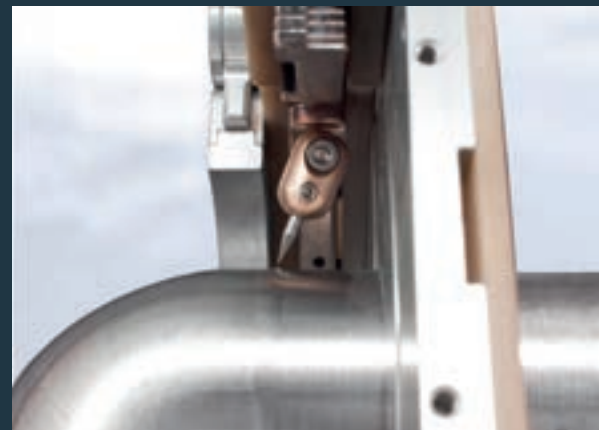
Schwenkbarer Elektrodenhalter für Rohr - Rohrbogen Anwendungen
