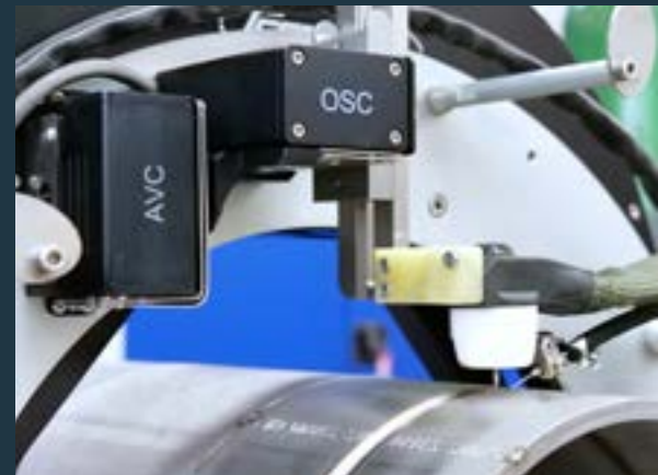
Optionale AVC / OSC Einheit, kompatibel mit FOH 20-114, FOH 40-168 und FOH 88-273
