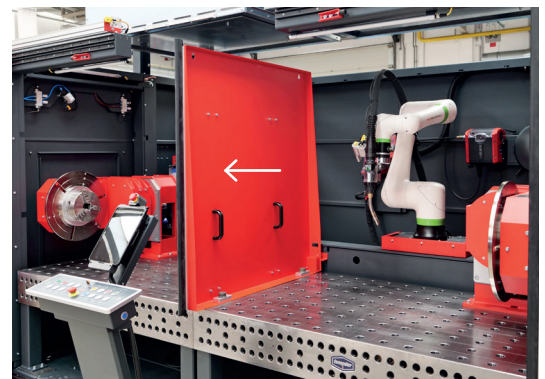
Manuell entfernbare Trennwand für 1-Stationenbetrieb
