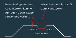
Der Absenkstrom wird nur beim WIG-4-Takt-Schweißen verwendet. In diesem Modus können Sie den Hauptstrom während des Schweißprozesses beliebig verringern oder erhöhen.
