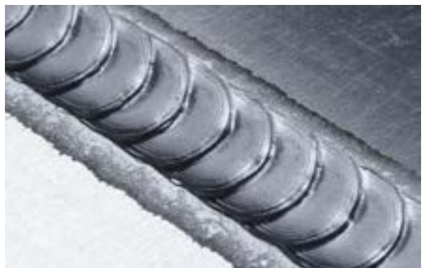
Lap joint 3 mm aluminum Vd: 7,7 m/min Vs: 50 cm/min
