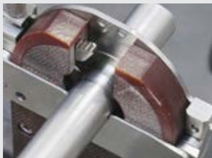
/ Hochwertige Schweißergebnisse durch geschlossene Schutzgaskammer
