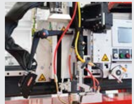
/ Schweißkopf mit AVC/OSC, Kamera
