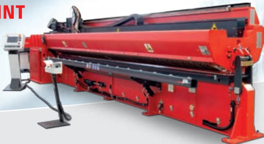
Die Längsnaht Schweißsysteme FCP 4100 - 8100 INT sind speziell zum Innenschweißen von zylindrischen Bauteilen mit großem Durchmesser z.B. im Tank- & Behälterbau.
