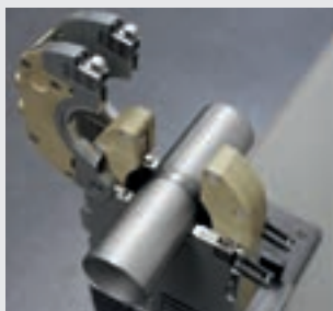
/ Dokonalé zvarové švy vďaka zatvorenej komore
