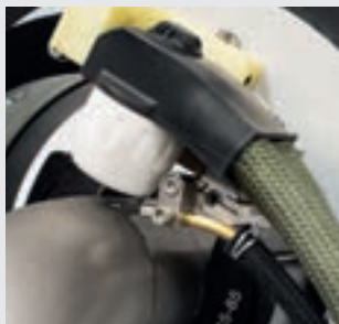
/ Privádzanie drôtu, plynule otočná hlavica zváracieho horáka v rozsahu 0 – 45°
