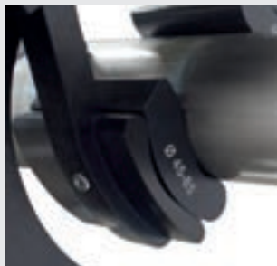
/ Redukčné čeluste v závislosti od priemeru rúry
