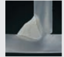
/ Soldadura en ángulo de acero de 10 mm
