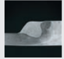
/ Soldadura solapada de acero de 3 mm
