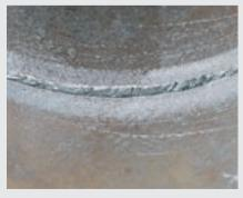
/ Отличные результаты при сварке трубопроводов электродами с целлюлозным покрытием. Оптимизированные свойства дуги предотвращают ее разрыв и прилипание электрода. Результат — совершенно однородный корень шва.
