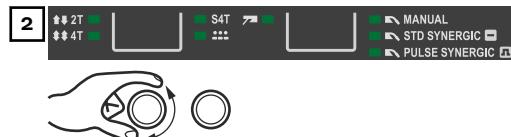
S pomoću tipki Način rada i Postupak zavarivanja ili okretnog gumba slijeva odaberite željeni parametar za postavljanje
