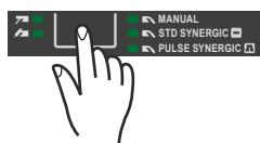
S pomoću tipke Postupak odaberite postupak MIG/MAG standardno-sinergijsko zavarivanja
