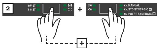
Upravljačka ploča nalazi se sada u izborniku Postavljanje postupka „MIG/MAG standardno sinergijsko zavarivanje“ - prikazuju se posljednje odabrani parametri za postavljanje.
