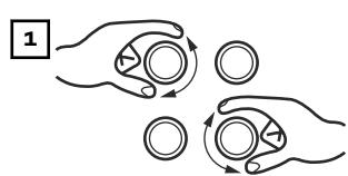
S pomoću okretnog gumba slijeva odaberite željeni parametar za postavljanje
