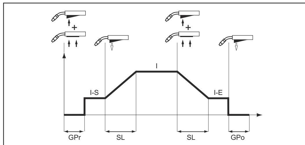
Način rada „Specijalni 4-taktni pogon“ nudi dodatno uz prednosti 4-taktnog pogona mogućnost namještanja za početnu i završnu struju.
