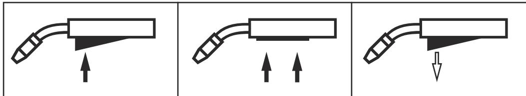
Pritisnite tipku gorionika / Držite tipku gorionika / Otpustite tipku gorionika
