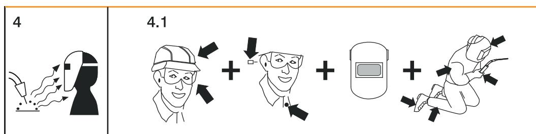
4. Zrake električnog luka mogu opeći oči i ozlijediti kožu.
