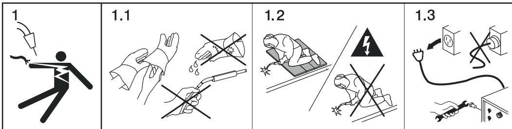
1. Strujni udar može biti smrtonosan.
