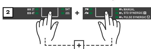
Upravljačka ploča nalazi se sada u izborniku Postavljanje postupka „MIG/MAG standardno sinergijsko zavarivanje“ - prikazuju se posljedne odabrani parametri za postavljanje.
