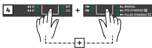
Upravljačka ploča nalazi se sada na drugoj razini u izborniku Postavljanje postupka „MIG/MAG standardno sinergijsko zavarivanje“ - prikazuju se posljednje odabrani parametri za postavljanje.
