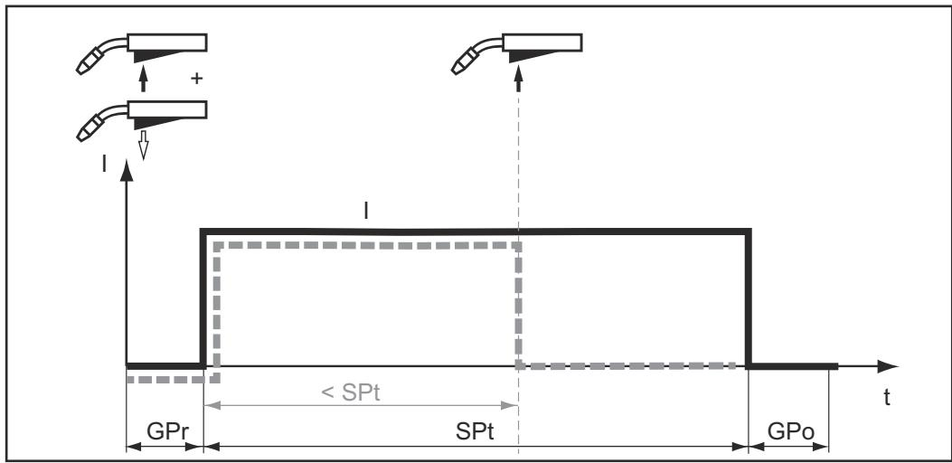
Način rada „Točkasto zavarivanje“ prikladan je za zavarene spojeve na preklopnim limovima.
