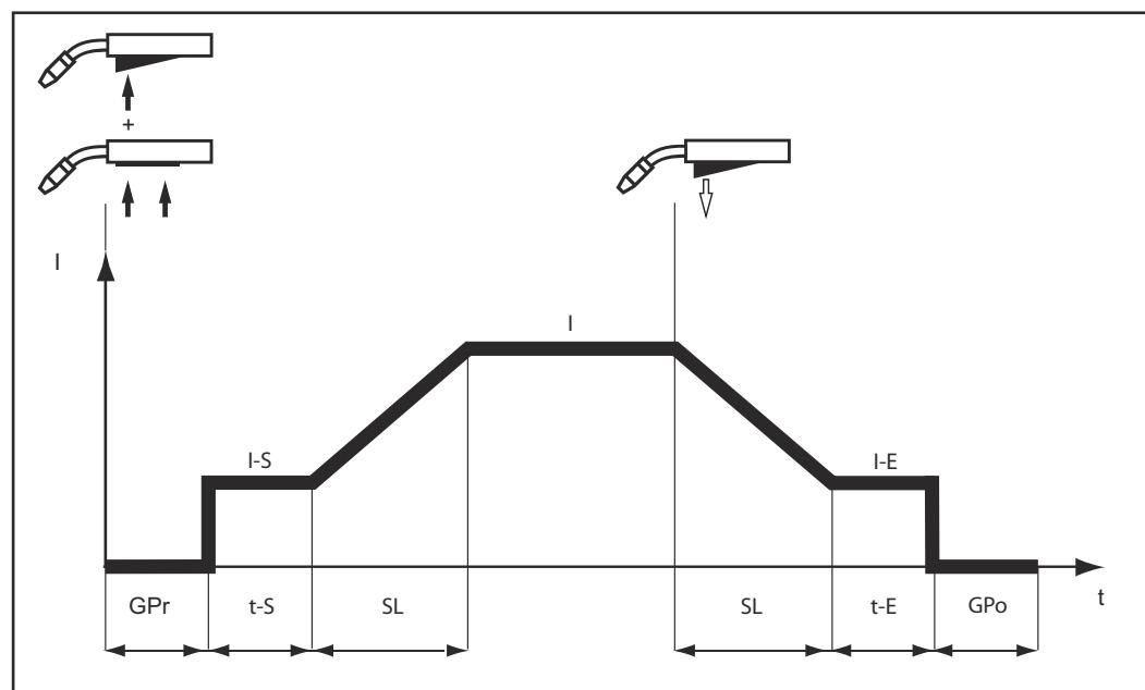
Način rada „Posebni 2-taktni pogon“ prikladan je osobito za zavarivanje u većim rasponima snage. U Posebnom 2-taktnom pogonu električni luk počinje s malom snagom, a rezultat je jednostavnija stabilizacija električnog luka.
