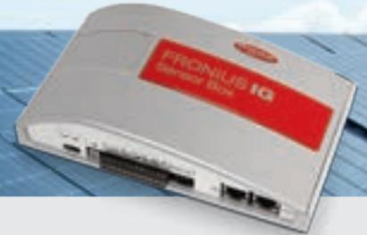
/ Mit der Fronius Sensor Card / Box können bis zu sechs Sensoren zur Messung der Einstrahlung, Umgebungstemperatur, Modultemperatur, Windgeschwindigkeit usw. in das Fronius DATCOM-System integriert werden. Bereits mit Einstrahlung und Modultemperatur kontrollieren Sie Ihr PV-System und können Abweichungen in der Anlagenleistung schneller entdecken und die Performance auf konstant hohem Niveau halten. Sie können zwischen einer Box und einer Card wählen.
