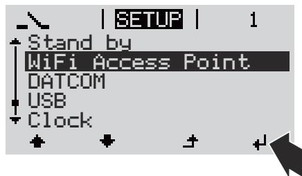
El inversor establece el punto de acceso inalámbrico. El punto de acceso inalámbrico permanece abierto durante 1 hora. El interruptor IP en el Fronius Datamanager 2.0 puede permanecer en la posición de interruptor B gracias a la activación del punto de acceso inalámbrico.
