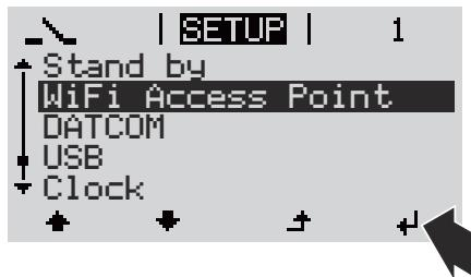
L'onduleur établit le point d'accès WLAN. Le point d'accès WLAN reste ouvert pendant 1 heure. Le commutateur IP sur le Fronius Datamanager 2.0 peut rester en position de commutation B avec l'activation du point d'accès WLAN.
