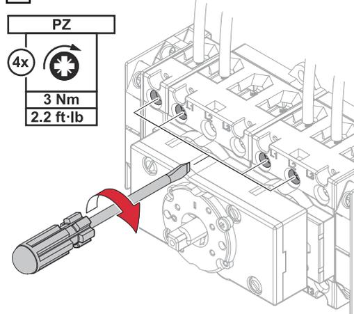
Atornillar el conductor individual (L1) y el conductor neutro (N) en los bornes de conexión. Atornillar los dos conductores neutros (N') en los bornes de conexión. Para obtener información sobre los tornillos de conexión y los pares permitidos, véase [Tornillos de conexión admisibles](#) en la página 19.
