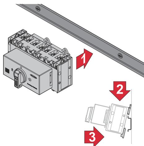
El Fronius Backup Switch puede montarse en un carril DIN de 35 mm.
