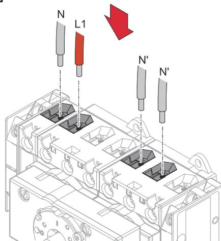
Insertar el conductor individual (L1) procedente de la red y el conductor neutro (N) procedente de la red en los bornes de conexión. Insertar los dos conductores neutros (N') del circuito de energía de emergencia en los bornes de conexión.
