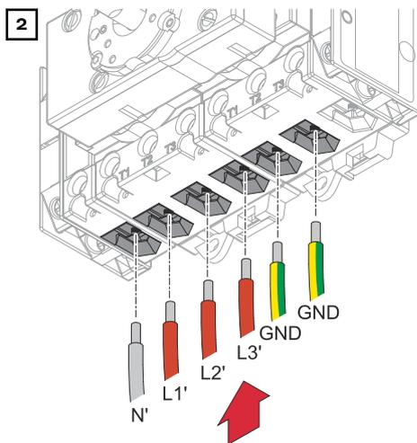
Insertar los conductores individuales (L1', L2', L3') procedente del circuito de energía de emergencia y el conductor neutro (N') procedente del circuito de energía de emergencia en los bornes de conexión. Insertar el cable de tierra (GND) del cableado doméstico en los bornes de conexión previstos.
