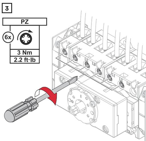
Atornillar los conductores individuales (L1, L2, L3) y el conductor neutro (N) en los bornes de conexión. Atornillar los dos conductores neutros (N') en los bornes de conexión. Para obtener información sobre los tornillos de conexión y los pares permitidos, véase [Tornillos de conexión admisibles](#) en la página 19.
