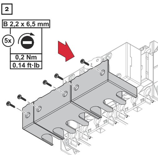
Montar una cubierta protectora inferior en todos los seccionadores de carga de 63 A. Para el montaje deben utilizarse los tornillos incluidos en el volumen de suministro.
