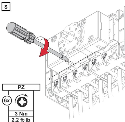
Atornillar los conductores individuales (L1', L2', L3') y el conductor neutro (N') en los bornes de conexión. Atornillar el cable de tierra (GND) del cableado doméstico en los bornes de conexión.
