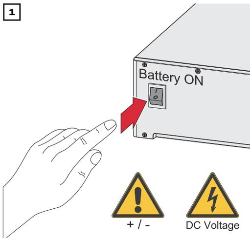
Encender la batería conectada al inversor.
