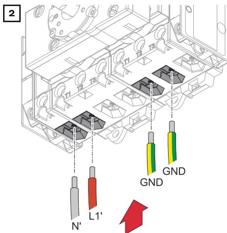
Insertar el conductor individual (L1') procedente del circuito de energía de emergencia y el conductor neutro (N') procedente del circuito de energía de emergencia en los bornes de conexión. Insertar el cable de tierra (GND) del cableado doméstico en los bornes de conexión.
