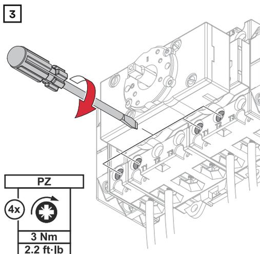
Atornillar el conductor individual (L1') y el conductor neutro (N') en los bornes de conexión. Atornillar el cable de tierra (GND) del cableado doméstico en los bornes de conexión.
