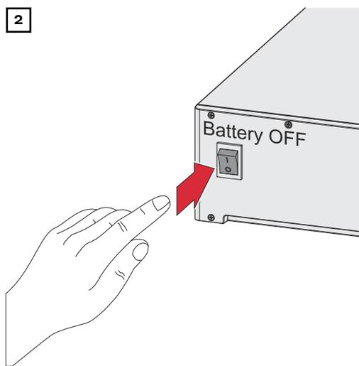
Desconectar la batería conectada al inversor.
