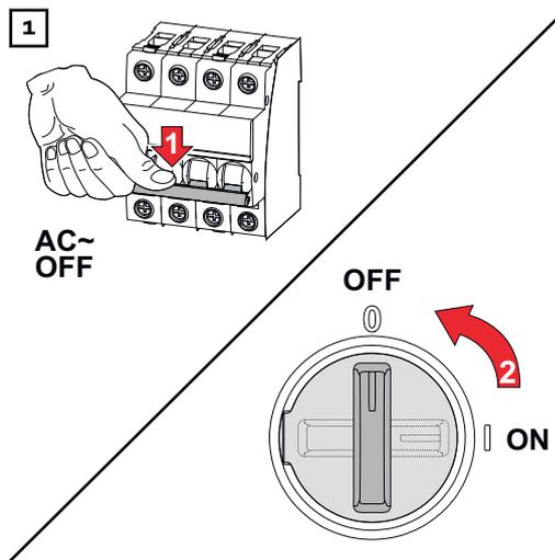
Desconectar el disyuntor automático. Poner el interruptor del seccionador CC en "(OFF)" (DES).
