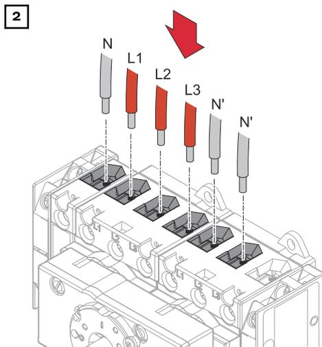
Insertar los conductores individuales (L1, L2, L3) procedentes de la red y el conductor neutro (N) procedente de la red en los bornes de conexión. Insertar los dos conductores neutros (N') del circuito de energía de emergencia en los bornes de conexión.
