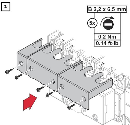
Montar una cubierta protectora superior en todos los seccionadores de carga de 63 A. Para el montaje deben utilizarse los tornillos incluidos en el volumen de suministro.
