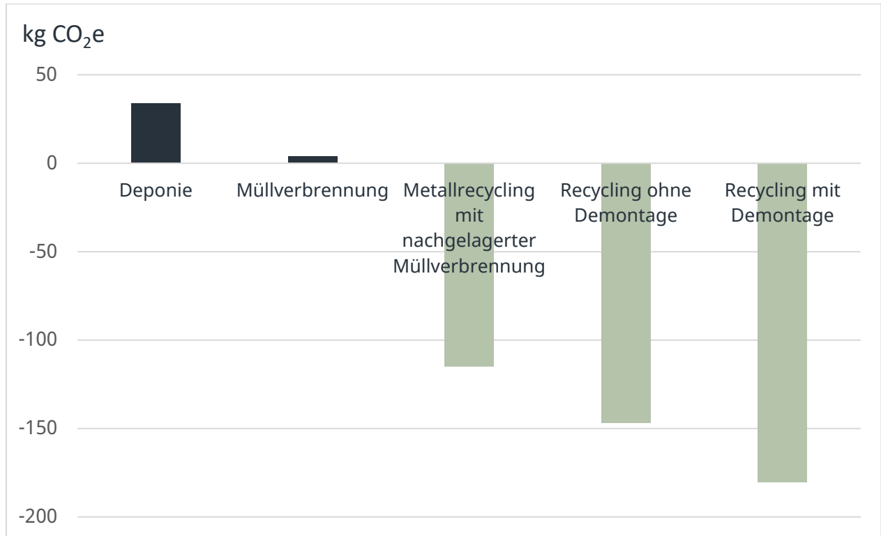
Abb. 5: Umweltkosten bzw. -nutzen von End-of-Life-Prozessen des Tauro ECO 100-D. Bei Deponierung kommt es zu weiteren Emissionen. Der Umweltnutzen steigt mit dem Recycling von Metall und wird optimal in Verbindung mit der Demontage der Hauptbauteile des Tauro.
