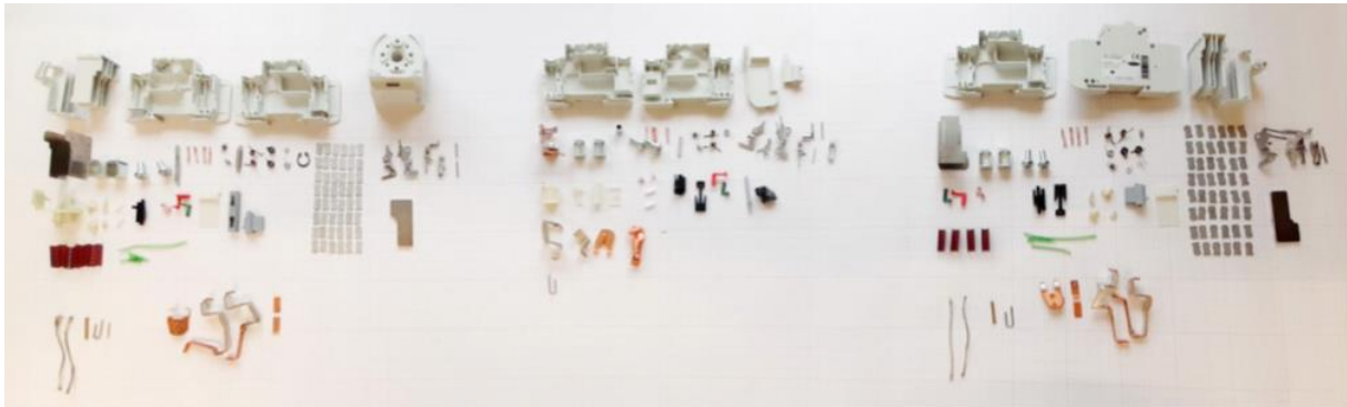
Bild 1: Kleinteilige Zerlegung eines DC-Trennschalters des Tauro ECO zur weiteren LCA-Modellierung
