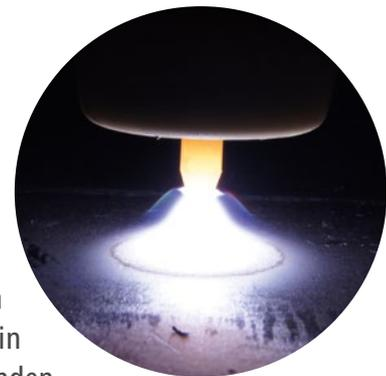
Das Wolfram-Inertgasschweißen, oder kurz WIG-Schweißen, wurde bereits in den 1940er Jahren entwickelt. Dabei brennt ein Lichtbogen zwischen einer nichtabschmelzenden Wolframelektrode und dem metallischen Werkstück in einer sauerstofffreien, reaktionslosen Gasatmosphäre. Der Anwender kann Schweißzusätze in Form von Stäben oder Drähten zusätzlich in den Lichtbogen zuführen und abschmelzen, um eine gegebenenfalls notwendige Nahtfüllung zu gewährleisten.
