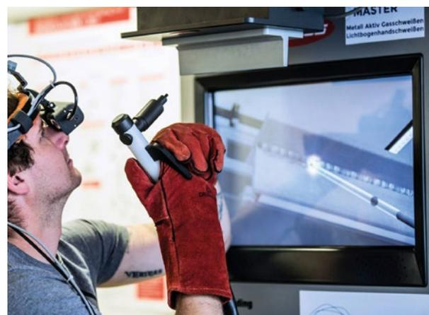
*„Durch den virtuellen Trainer, der die richtige Brennerhandhabung vermittelt, kann das szf mit Hilfe von Virtual Welding von Fronius eine Eins-zu-eins-Betreuung in der Schweißausbildung realisieren.“*
