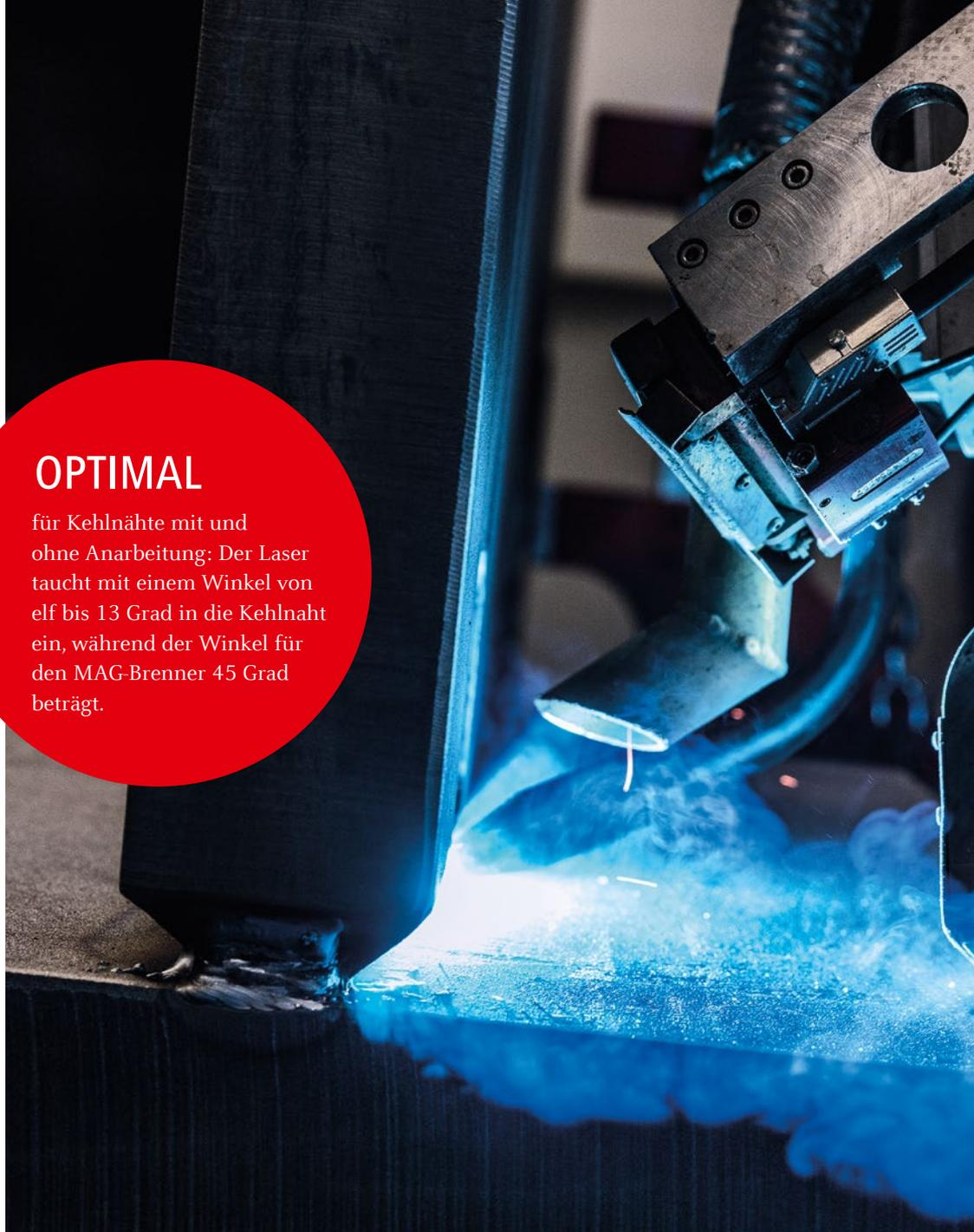
/TRUMPF nutzt den Laser des LaserHybrid-Kopfes zum Vorwärmen des Nahtbereichs und kann so auf das energieintensive und aufwändige Glühen des Maschinenrahmens nach dem MAG-Schweißen verzichten.
