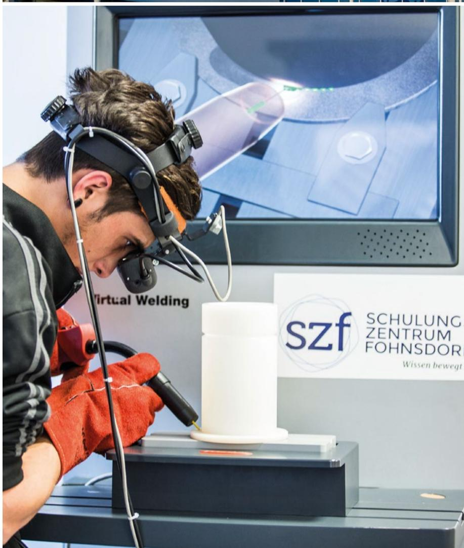
/ Durch die VR-Brille, mit der die Schweißnaht betrachtet werden kann, entsteht der Eindruck von realem Schweißen. Die Schüler trainieren das Handling mit einem originalgetreuen Schweißbrenner.
