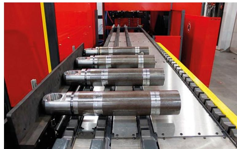
/ Bauteil-Transportsysteme führen die zu schweißenden Teile der Anlage zu.
