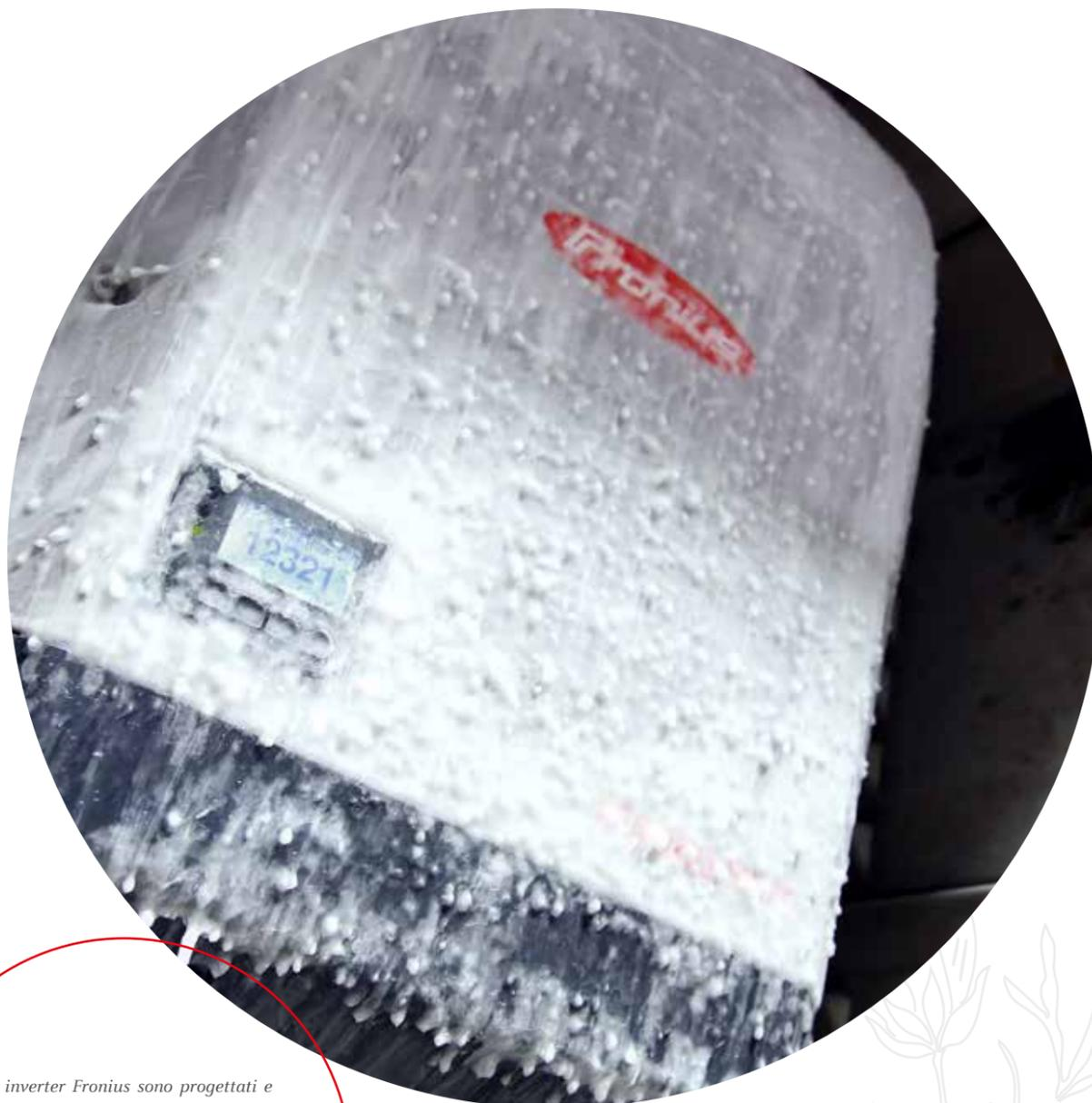
Gli inverter Fronius sono progettati e prodotti per poter resistere e produrre anche in condizioni estreme di utilizzo. Nell'immagine, un inverter in produzione durante il test climatico eseguito nel laboratorio di prova Fronius.
